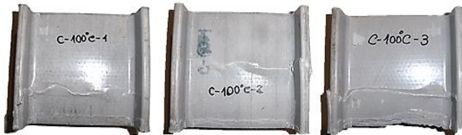
Figura B.5: Modos de rotura de provetes ensaiados à compressão a 100 °C.
