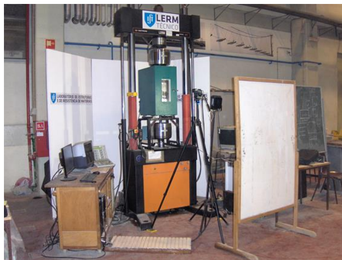
Figura 29: Vista geral do esquema de ensaio e instrumentação utilizada nos ensaios de corte.
