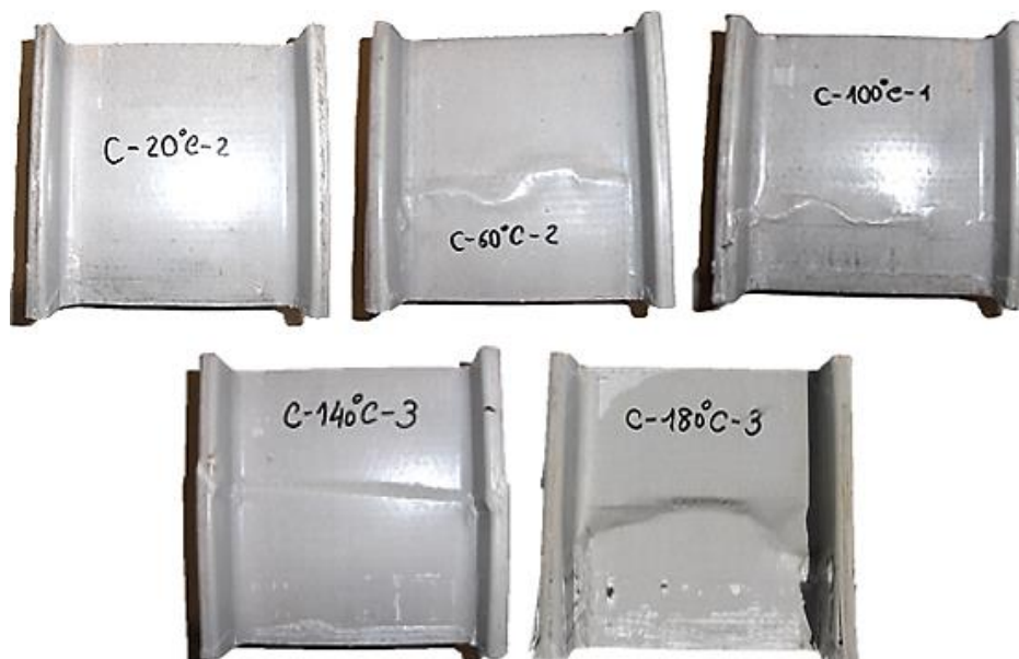
Figura 94: Modos de rotura característicos de provetes ensaiados à compressão a, da esquerda para a direita e de cima para baixo: 26 °C, 60 °C, 100 °C, 140 °C e 180 °C.
