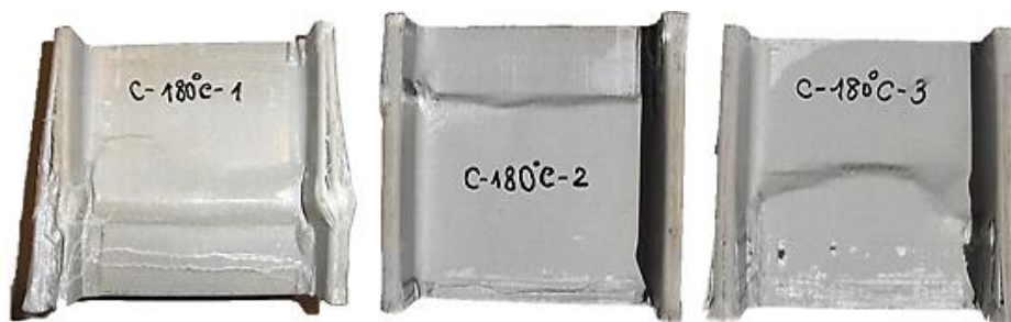
Figura B.7: Modos de rotura de provetes ensaiados à compressão a 180 °C.
