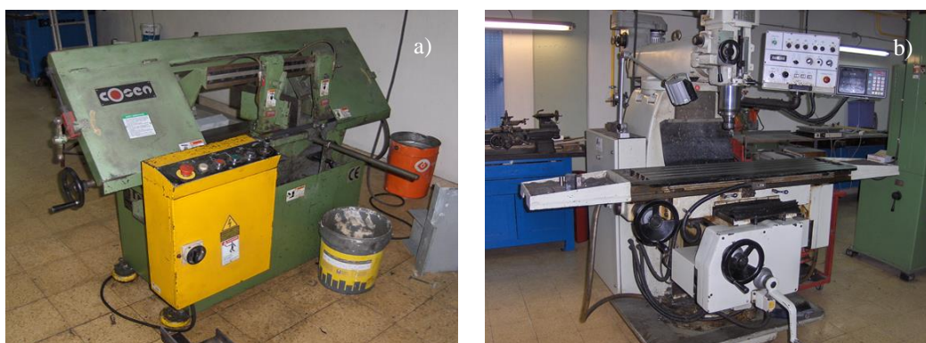
Figura 37: Equipamentos utilizados para corte e preparação dos provetes para ensaios de compressão: a) serra de fita; b) fresa.
