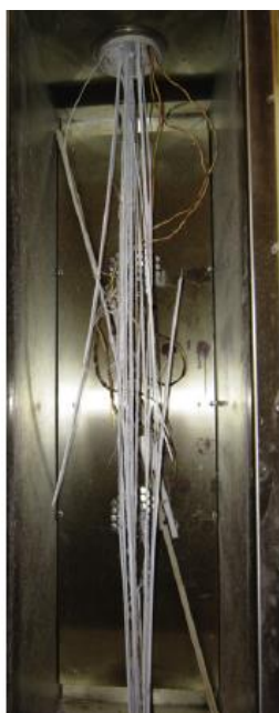
Figura 14: Modo característico de rotura de provetes solicitados à tracção [19].
