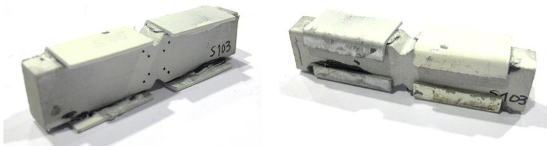
Figura 62: Reforços metálicos: vista da face frontal (esq.); vista da face posterior (dir.).
