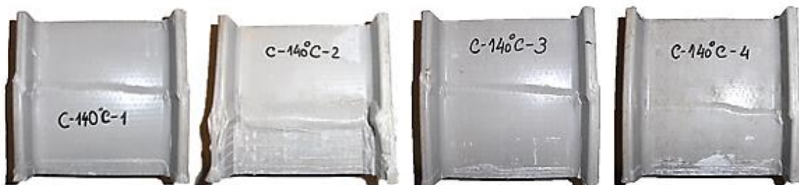
Figura B.6: Modos de rotura de provetes ensaiados à compressão a 140 °C.
