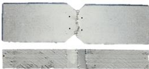
Figura 60: Modo de rotura esperado de provetes ensaiados ao corte: rotura por corte.
