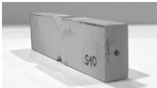
Figura 32: Pormenor do furo na secção transversal do provete.
