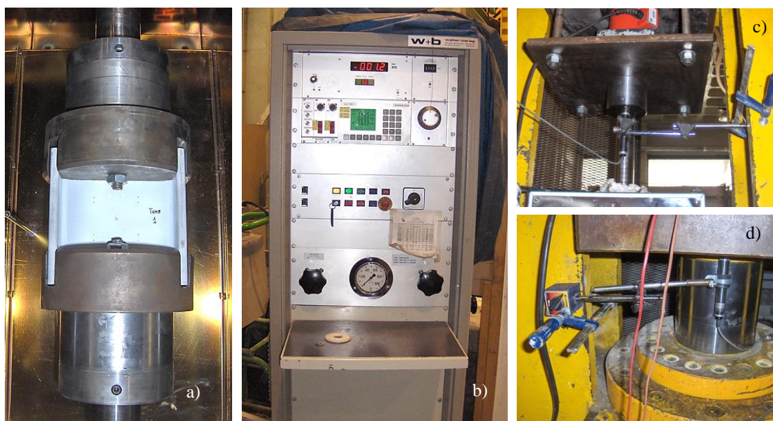
Figura 36: Pormenores do esquema de ensaio de compressão: a) suporte do provete no interior da câmara; b) unidade de pressão; c) deflectómetro superior; d) deflectómetro inferior.
